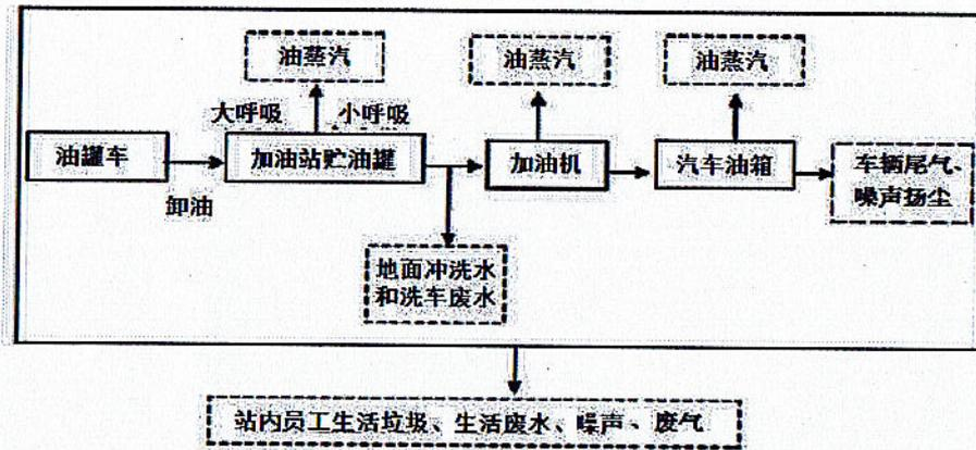
图 1 加油工艺流程和产污节点图
