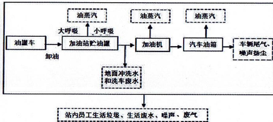
图 1 加油工艺流程和产污节点图
