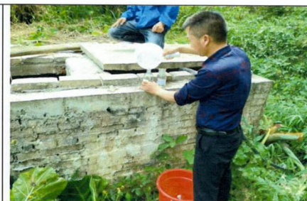
项目下游地下水采样
