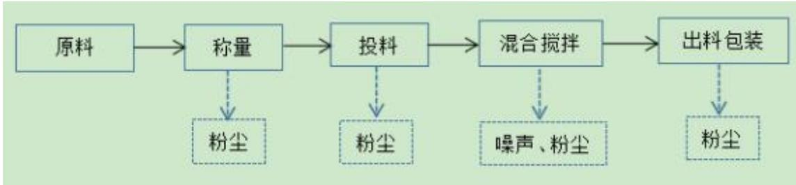
图2-2 腻子粉生产工艺流程及产污情况
