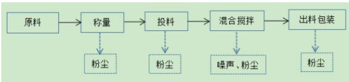
图2-3 砂浆生产工艺流程及产污情况
