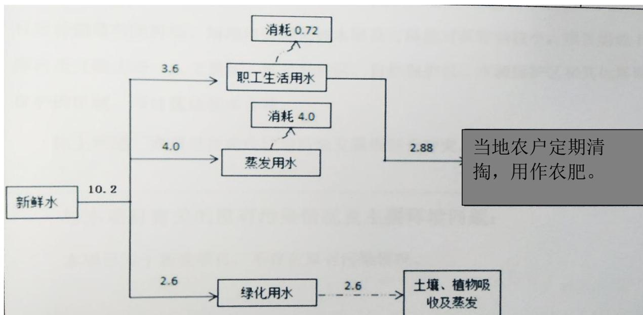
图 2-2 项目水平衡图 (t/d)
