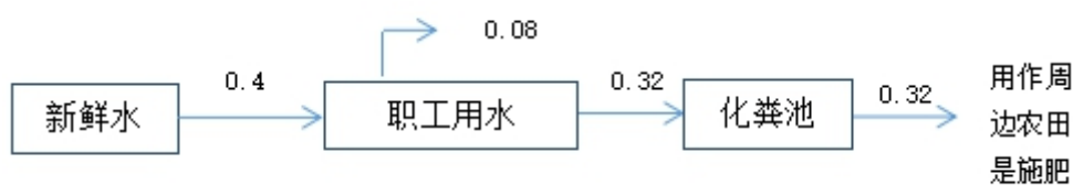
图 2-2 项目水平衡图 (t/d)
