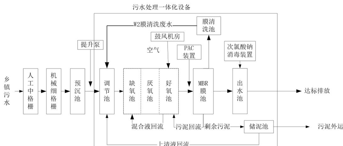
图 2-2 运营期工艺流程和产污节点图
