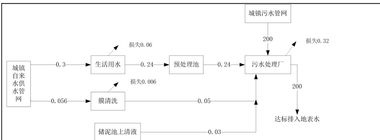
图2-1 项目水平衡图 (m³/d)
